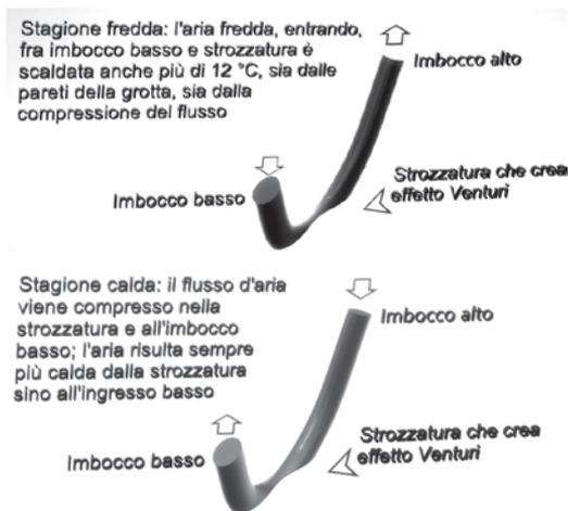
Fig. 8 – Modello (estremamente) semplificato della galleria: la forma a tubo incurvato verso l'alto, con una strozzatura e con l'imbocco basso più stretto del tubo spiega sia l'elevatissimo gradiente termico verticale invernale, sia il gradiente inverso estivo.
